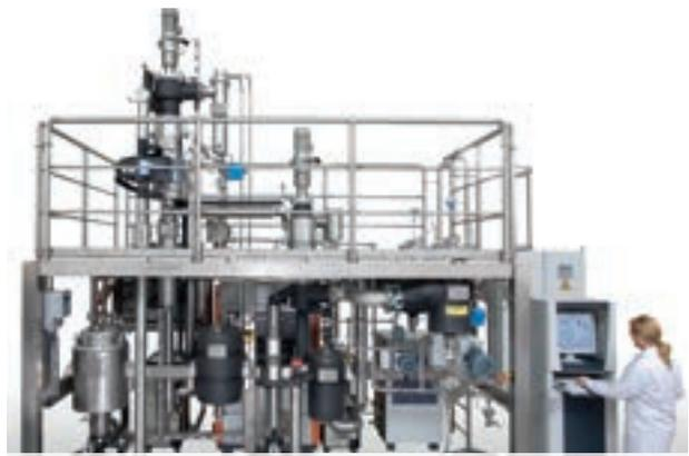
Dünnschichtverdampfer-Kurzwegverdampfer mit Steuerung/Visualisierung
