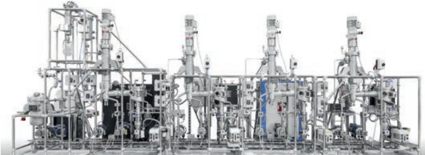
Mit mehrstufigen Anlagen lassen sich komplexe Stoffgemische in Einzelfractionen gewünschter Reinheit auftrennen.
